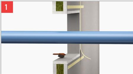
1 Öffnung reinigen und alle losen Teile entfernen und Bauteilöffnung umlaufend 2 cm größer als die Rohbauöffnung abkleben.
